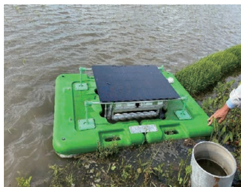
▲水田の中を自律走行することで雑草の光合成を妨げる「アイガモロボット」
