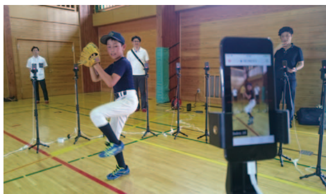
▲被写体中心360°カメラの実証試験
