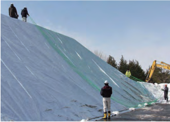
▶約500トンの雪山を造成した「貯雪実験」(雪山の高さ約6メートル)
